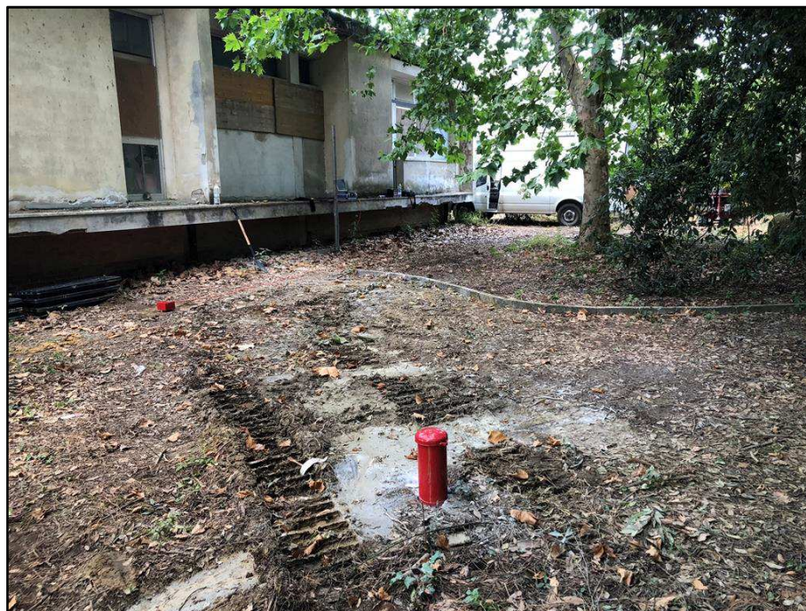
Fig. 10: Postazione misura di rumore a stazione singola HVSR
