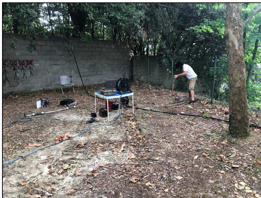
Fig. 9: Postazione della prova sismica in foro Down-Hole
